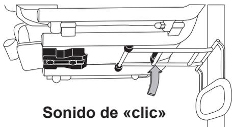
2 Cuando no se utiliza, el soporte lateral está acoplado al soporte situado debajo de la camilla. Para utilizar el soporte lateral: Libérela de la posición de bloqueo. (Véase la fig. 3)
